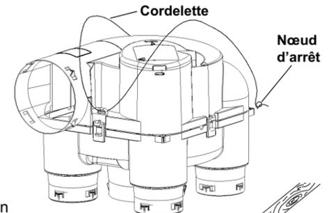
3 Raccorder le conduit souple Ø 125 de la cuisine au piquage central (non démontable) en prenant soin de le recouvrir suffisamment afin d'obtenir une bonne étanchéité.
